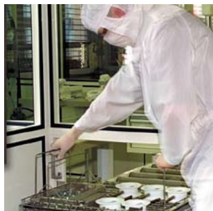
Шлюз подачи материалов
